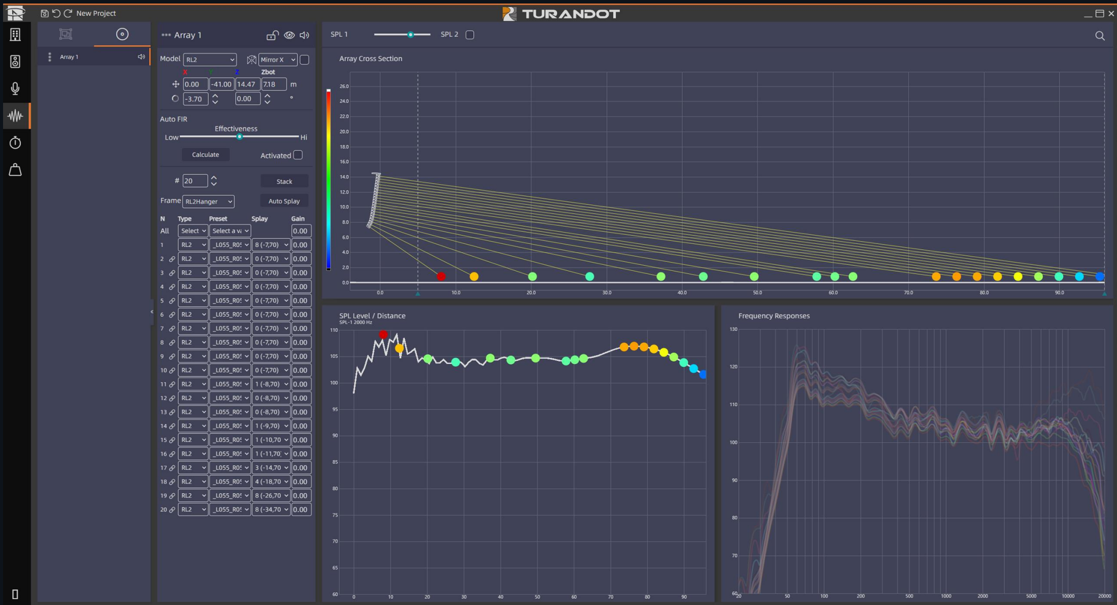
图为一个创建好的 RL2 线阵列示例，在设置好箱体间距后，且未计算或激活AUTO FIR。
